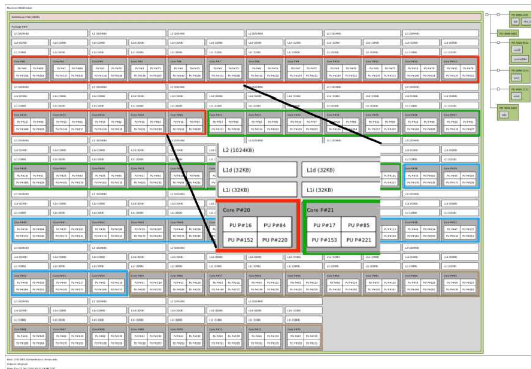
图 45.6: Intel Knights Landing 上的进程和线程放置
